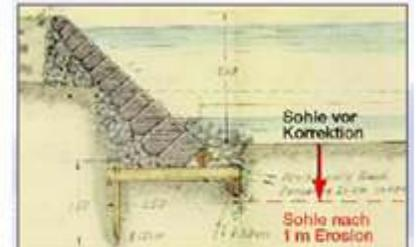
Die Zeichnung verdeutlicht die Problematik der Sohlenerosion in der Kander. Bei einer Entleitung der Sohle um 1 m werden die Längshölzer freigelegt und sind der Verwitterung ausgesetzt. Bereits sind auf grosser Länge solche Schäden an den Uferverbauungen zu erkennen.
